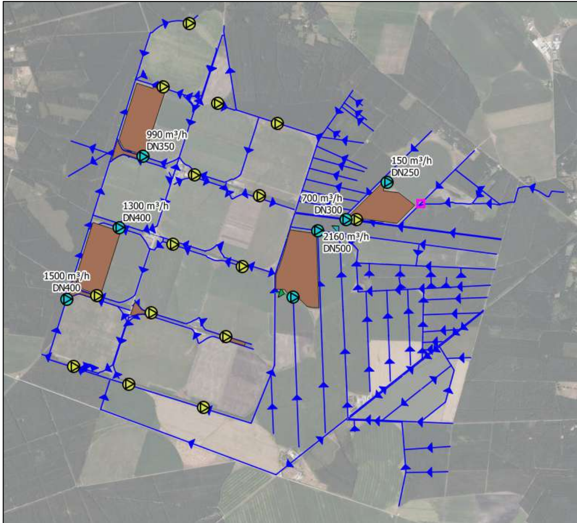
Figure 20 : Synoptique hydraulique des pompages
